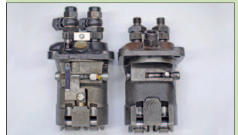
PFR-A-Pumpen für Zweizylindermotoren waren unter anderem an MAN, Güldner und Kramer (mit Güldner-Motor) angeschraubt
