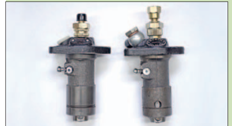
Bosch-PFR-Pumpen der Baugröße A saßen oft in MWM-Motoren. Fendt F 12 aus den fünfziger Jahren etwa haben sie eingebaut
