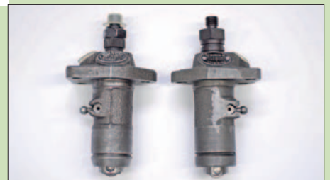
PFR-K-Einspritzpumpen für Einzylinder-Schlepper fördern den Kraftstoff im Eicher G13 und Fahr D 66 – um nur zwei zu nennen
