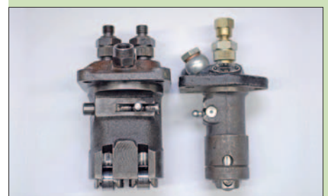
Für Dreizylindermotoren gab es entweder die hier abgebildete Kombination oder drei Pumpen in einem Gehäuse vereint
