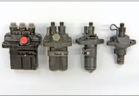
OMAP-Pumpen aus Italien kommen bei Deutz, Same, aber auch Fendt vor. Sie waren mal Bosch-Lizenzbauten und früher daher kompatibel
