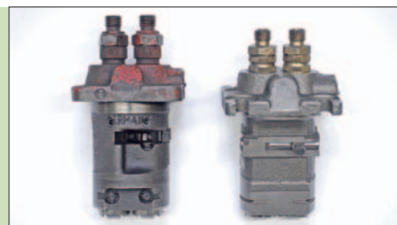
Anhand dieser beiden Bosch-PFR-2-K-Pumpen wird sehr deutlich, wie unterschiedlich die Flansche zum Befestigen ausfallen können
