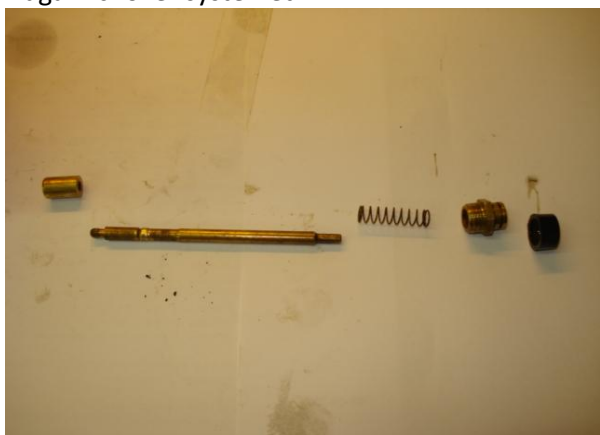
Puds choker pinden med ståluld til den er glat.
